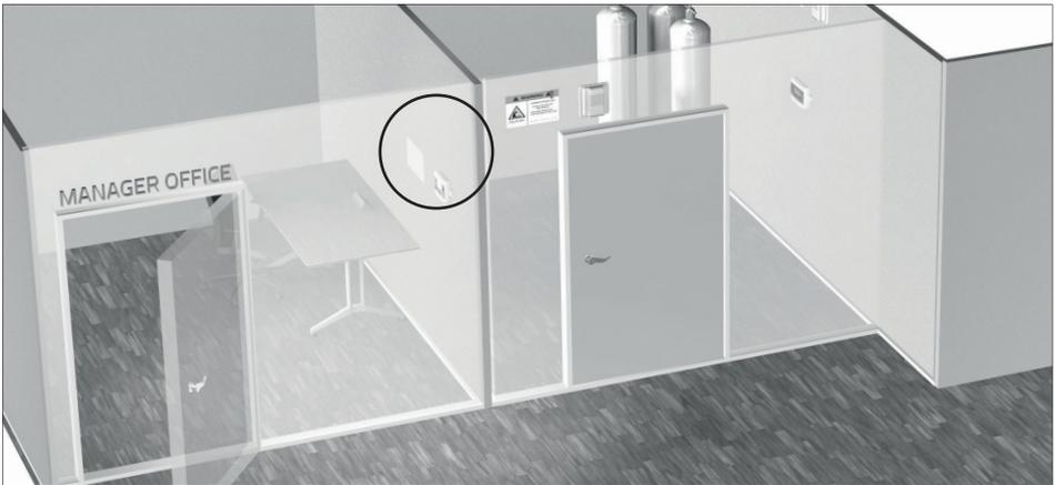
1. Si votre ensemble inclut une unité centrale, elle doit être installée à l'extérieur de la zone ou de la pièce surveillée, par exemple sur une paroi du bureau du responsable. L'unité centrale doit être installée à une hauteur clairement visible et accessible.
