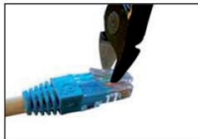
切斷 RJ45 連接器的鎖扣延長部分，確保 CO<sub>2</sub> 安全系統未經授權的切斷
