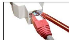
Corte las prolongaciones del desbloqueo en los conectores RJ45 para evitar una desconexión desautorizada del sistema de alarma CO2.
